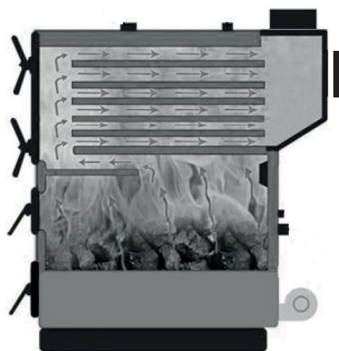
Рис. 5. Схема движения дымовых газов в трехходовом теплообменнике для котла VLK SRK-130-1500.
